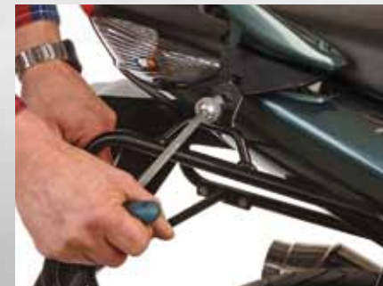
2. Obere Lock it Schraube lösen
