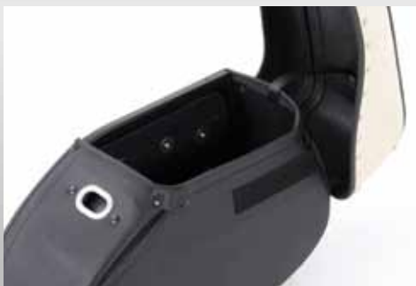
Stabilität durch verdeckte Form- und Verstärkungsteile; Toplader mit Deckelhalter
