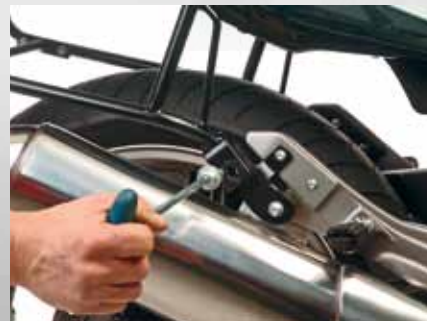
So einfach und schnell funktioniert es: 1. Untere Lock it Schraube lösen
